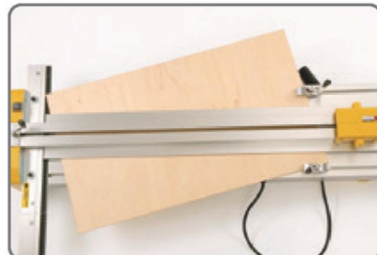
材料押さえクランプは斜め切りの際、補助的に使用します。
