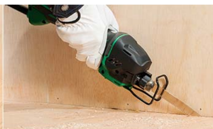
隅やキワの切断作業
