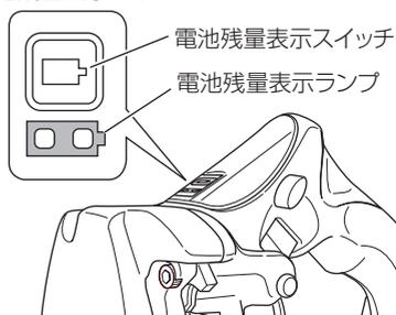
**注** 電池の消耗を少なくするため、電池残量表示スイッチを押している間のみ、ランプが点灯します。
