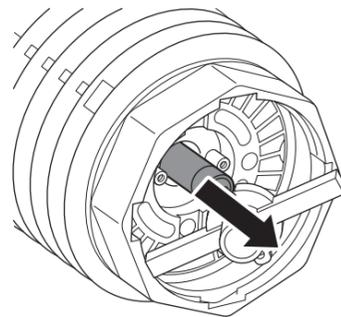
誘虫灯のソケット差し込み穴の位置を確認しながらソケットを取り付けてください。固定ねじ(2ヶ所)を確実ににはめてソケットを固定してください。虫受け皿を取り付けて交換完了です。
