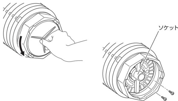
ソケットの固定ねじ(2ヶ所)をドライバーで緩めて外し、ソケットを外します。
