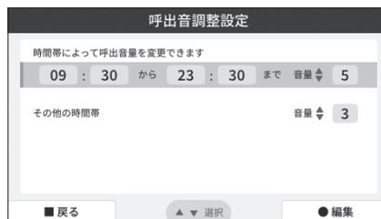
※ その他の時間帯の音量レベルは、呼出音量設定の音量レベルと連動しています。
