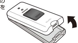
③ リチウム電池の極性を確認して電池ケースにセットします。
