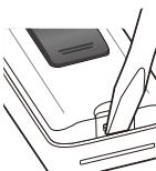
② 押ボタン本体下部の溝から電池カバーをはずします。
