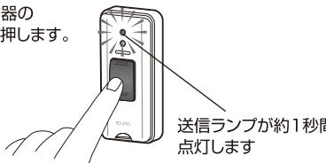
送信ボタンを約5秒間長押しで送信ランプが2回点滅し、暗センサーがオフになります。その状態でもう一度長押しすると送信ランプが1回点滅し、暗センサーがオンになります。※電池交換するとオンに設定されます。
