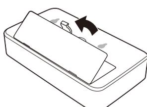
②単三形乾電池3本を電池の極性を確認してセットし、電池カバーを元通りに閉じます。
