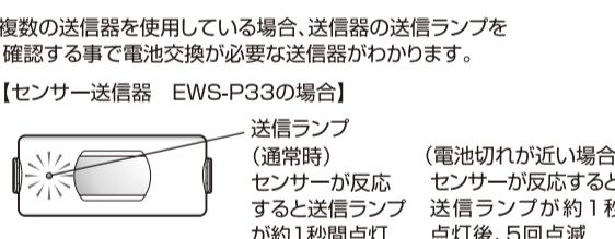
・複数の送信器を使用している場合、送信器の送信ランプを確認する事で電池交換が必要な送信器がわかります。
