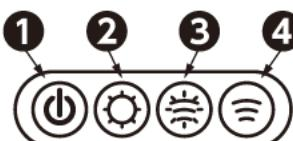
ON/OFFスイッチで電源を入れ、各モード切替スイッチで点灯モードを切替えできます。
