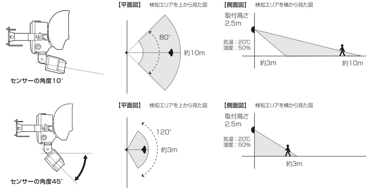
※センサーは検知エリア内の温度変化を検知するため、人以外の熱源(動物・車など)も検知します。
