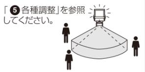
② 消灯後検知エリアを横切るように歩きランプが点灯する事を確認します。続いて検知エリア外へ移動すると約5秒後にランプが消灯する事を確認します。
