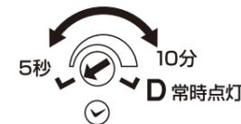
【D】常時点灯モード: 点灯開始照度で設定された照度になると、常時点灯します。
