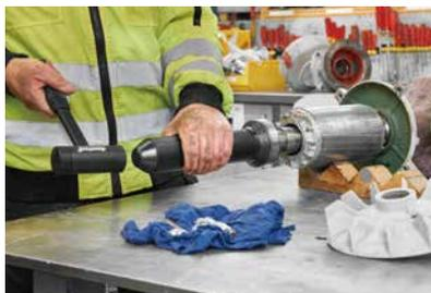
ベアリング挿入時の軸受け損傷を最小限にし、素早く作業できます。ブッシュ・シール・プーリーにも使用可
