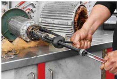
ベアリングの内輪・外輪のアームをロックするロッキングフック構造で、ハウジングとシャフトの間に組み込まれたボールベアリングを簡単に取り外し！
