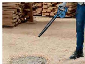
ノズルに延長パイプを装着した作業例。
