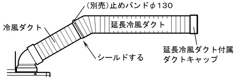
**注記** 排気ダクトのダクトキャップはボンドで固定されているので外れません。排気ダクトを延長する場合は、切断するか、ダクトキャップの上から延長ダクトをかぶせて接続してください。
