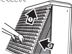
③ 背面の本体カバーとエレメントを固定している、固定フレームのビス8本をはずし、エレメントを取りはずしてください。洗淨する際はエレメントの内側から外側へ洗い流してください。内側はモーター側です。
