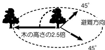
2. 伐り倒す木の周囲の障害物を取除き、足場の安全を確認します。伐り倒す木が斜面にある場合は、必ず山側に安全な足場を確保してください
