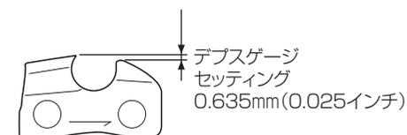
デブスゲージジョインターをソーチェンの上に乗せ、溝の部分からデブスゲージをのぞかせ、デブスゲージジョインターから出ている部分を平ヤスリですり落としてください。(デブスゲージジョインターは別売部品です。平ヤスリは市販品をお使いください。)
