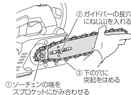
**注** サイドカバー周辺の汚れを落としてから取付けてください。(P.34「サイドカバーおよびスプロケットの掃除」「チェンオイル吐出口とガイドバーの掃除」参照)
