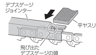
デブスゲージをすり落としたら、必ずデブスゲージの前側を元のように丸みをつけてください。
