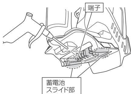
**注** 切りくずが付着したまま使用すると、使用中に蓄電池が落下するなど、事故の原因になります。また、蓄電池と端子の接触不良や故障の原因になります。
