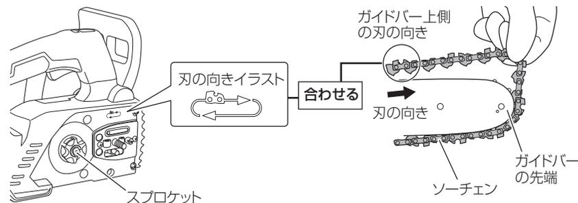
ソーチェンがガイドバーからはずれないように先端を押さえながら、右のイラストのようにソーチェンの端をスプロケットにかみ合わせ、ガイドバーを取付けます。
