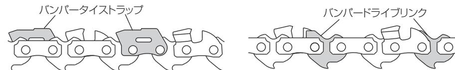
デブスゲージはカッターが木材にくい込む深さを調整する役割をしますので、デブスゲージを全部一定にそろえることが大切です。
