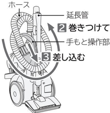
パットとブラシを取り外すと、ホースを延長管に巻きつけて、延長管の差し込み穴にスタンドフックを差し込めます。
