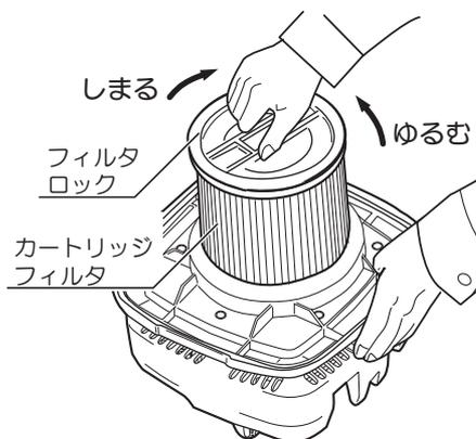
3. タンクの上でカートリッジフィルタの表面を軽くたたいて付着した粉じんを落とします。
