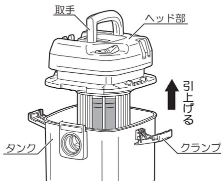
2. ヘッド部のフロートバスケットにカートリッジフィルタをさし込んで取付けます。
