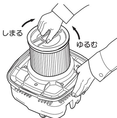
4. ヘッド部の前後方向を確認した後、タンクにヘッド部をさし込みます。
