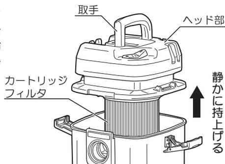
2. ヘッド部を下にして、フィルタロックをゆるめて、カートリッジフィルタを抜取ります。
