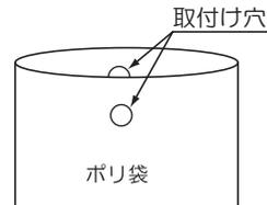
3. ポリ袋をタンクの内面に沿って広げた後、ポリ袋の端部をタンクの外に引き出します。
