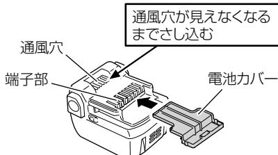
注 リチウムイオン電池を保管するときは、満充電にして保管してください。蓄電池の残量が少ない状態で長期間（3か月以上）保管すると蓄電池が劣化し、使用時間が著しく短くなったり、充電できなくなる恐れがあります。
