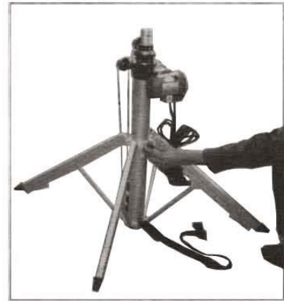
3. スライドリングのネジを締めます。
