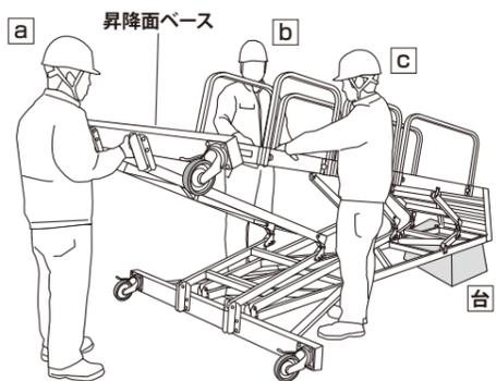
9. 作業員 b c が中折れツナギが直線になるまでさらに支柱を持ち上げます。作業員 a はベース中折れツナギ、下部中折れツナギ、上部中折れツナギの順に、ロックピンを①引き抜き②回転③差し込みの順に操作し、ロック付ヒンジを固定してください。
