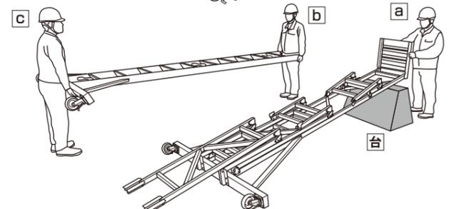
5. 作業員 c が昇降面ベースを持ち上げ、作業員 a b は昇降面を持ち支えながら支柱と天板を六角ボルト M8×25、平座金、ゆるみ止めナットで取り付けてください。
