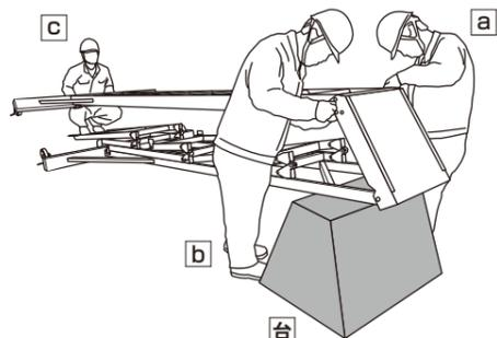
6. 作業員 a b が左右の昇降面支柱を持ち支えてください。作業員 c がベース中折れツナギを昇降側ベースへ六角ボルト M8×25、ばね座金、平座金で取り付けてください。続いて、作業員 c が昇降面ベースを持ち支え、作業員 a b が下部中折れツナギ、上部中折れツナギの順に六角ボルト M8×25、平座金、ゆるみ止めナットで昇降面支柱へ取り付けてください。
