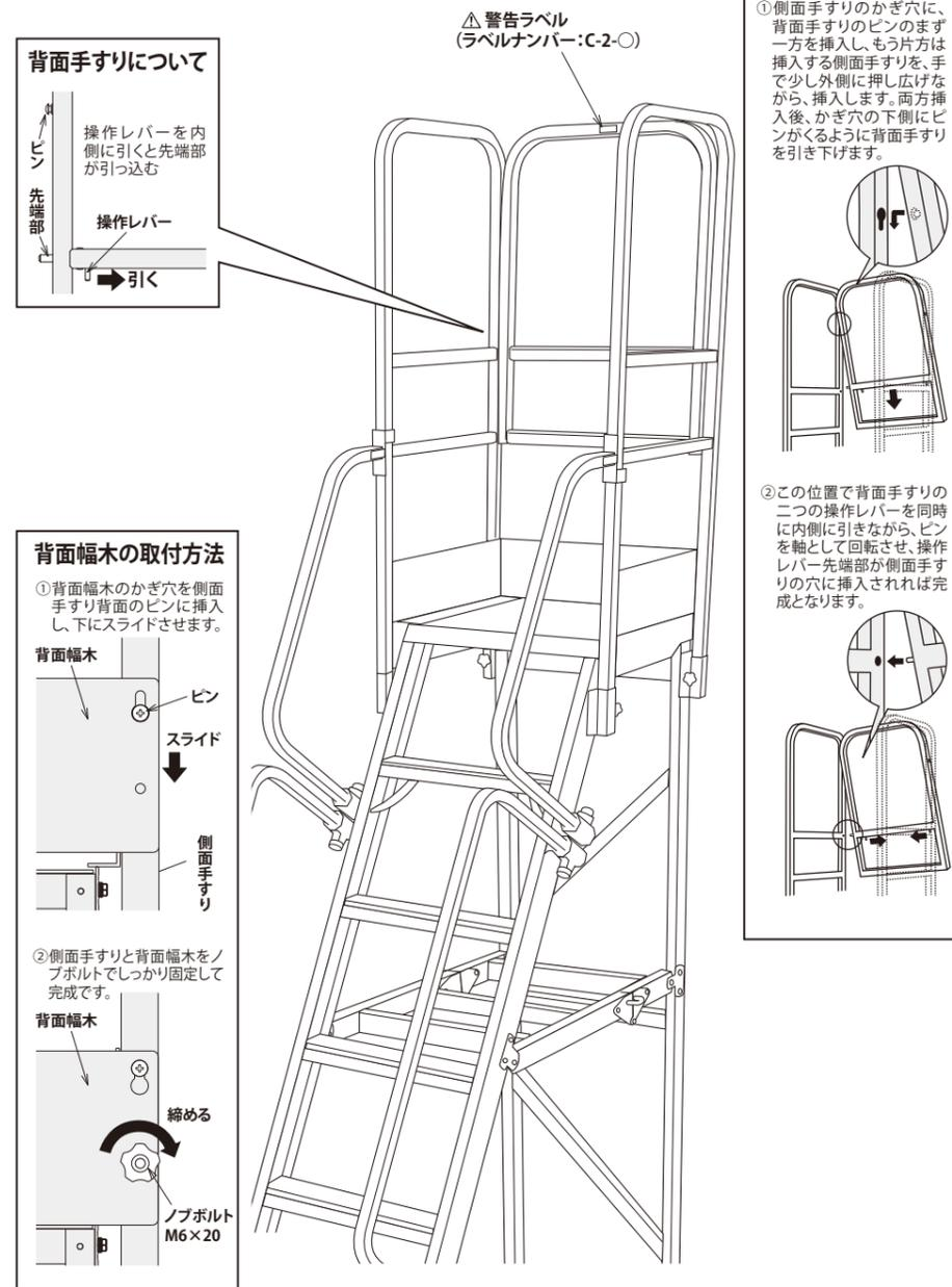
12. 全てのキャスターのロックをかけてください。(自在キャスターの向きは下図を参照してください。) 作業員 b c が左右の背面支柱をそれぞれ持ち上げて作業台をおこし、作業員 a はベース中折れツナギを持ち支えながら後ろへ下がり、ベース中折れツナギから昇降面ベースへ持ち替えて、ゆっくりと昇降面側のキャスターを着地させてください。
