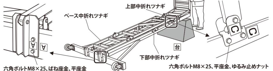
3. ベース中折れツナギ、下部中折れツナギ、上部中折れツナギの順に、ロックピンを①引き抜き②回転③差込の順に操作し、ロック付ヒンジを折り曲げてください。
