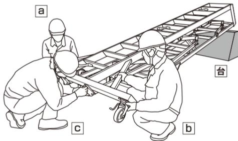
7. 作業員 a は下部昇降手すりを持ち支え、作業員 b が六角ボルト M6×20 (ばね座金、平座金付) で昇降面の支柱へ手すりブラケットを取り付けてください。下部昇降手すり(大)、(小)を両方使用する場合は、(小)が下側になるように取り付けてください。
