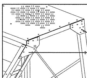
各部の接合部に割れや腐食がある場合、また、取付け部の破損、脱落、変形、磨耗がある場合には絶対に使用しないでください。
