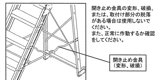
開き止め金具の変形、破損、または、取付け部分の脱落がある場合は使用しないでください。
