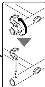
② 手すりフレーム (× 2) を下階フレームの上端部に差し込みます。
