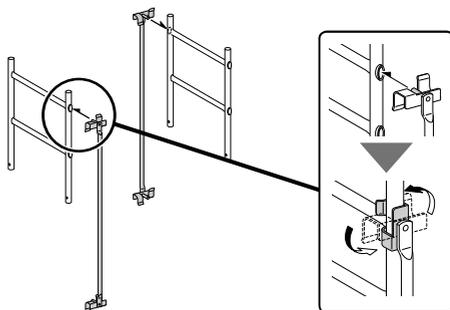
② 手すりフレーム(×2)を上階フレーム(上)の上端部に差し込み、ピンで固定します(4箇所)。
