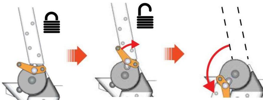
参考: ヒンジロックレバーを動かすのが固い時は、手すりをステップの前方に少し動かしながら解除して下さい。
