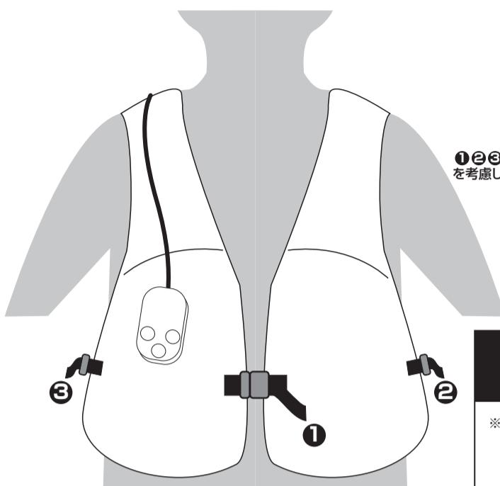
①②③ のベルトでベルチエデバイスの位置を考慮して、サイズ調節をしてください。
