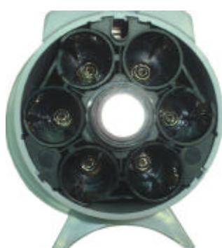
電池アダプター装着後 (単3電池使用時)
