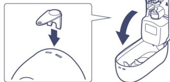
②中にセットされているカートリッジを手前に引き出し外します。
