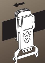
②ベルトにホルダーを取り付け確実にスライドロックをロックしてください。
