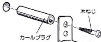
壁がコンクリートの場合は、 $\phi 6$  mmのドリルで深さ25 mmの穴をあけて、付属のカールプラグを差し込み、木ねじでしっかり固定してください。又、木壁の時は、そのまま木ねじで固定してください。(全8カ所)
