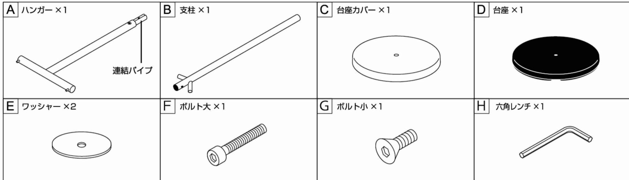
**1** 下図のようにボルト大、ワッシャー、台座、ワッシャー、台座カバー、支柱の順に挟み込み、六角レンチでしっかりと固定します。
