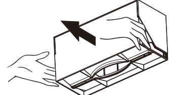
壁付・天井付とともに、カバー(黒色)の角を両手で挟みながら手前に引くと、カバーがスライドして取り外せます。カバー内にペーパータオルを補充し、カバーを逆の手順でスライドさせて取り付けます。
