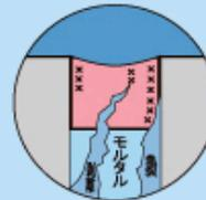
振動によって接着面に強い応力がかかり剥離しやすい。
