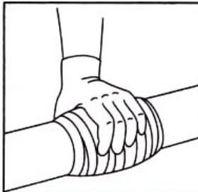
巻き付け後の終端は折り曲りを良く伸ばし、同時に手袋に水を付けて発泡が完了するまで樹脂を絞り込むように押えて表面を滑らかに仕上げます。硬化時の温度は24℃で約20分です。
