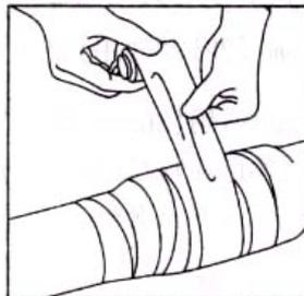
水から取り出した補修テープを5回以上補修箇所に強く引張りながら手早く巻き付けてください。⑦
