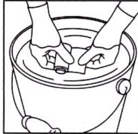
アルミバックから補修テープを取り出し、補修テープを水道水（海水でも可）に約5秒間浸してください。
