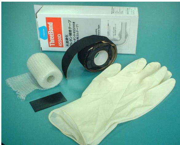
水分によって速硬化するウレタン補修テープと、水漏れしていても仮止水できるゴムテープを組み合わせた補修用セットです。配管の水漏れ、円柱物などへの巻き付け補強等に使用できます。
