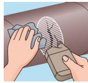
ケレン処理が終了したら、速やかに脱脂処理を行います。油やその他異物はたいてい表面下に染み込んでいるので、アセトン、MEK(メチルエチルケトン)など揮発性の高い溶剤を用いて脱脂処理を行って下さい。
