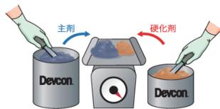
主剤と硬化剤を混合比率(重量比)に従って正確に秤で計量します。
