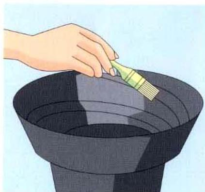
※金属表面にはプライマーFL-10を、続いてプライマーFL-20を塗布して十分乾燥させ、フレクサンを塗布。耐摩擦性を向上させるために厚みを少なくとも2mm以上付けて塗布すること。
