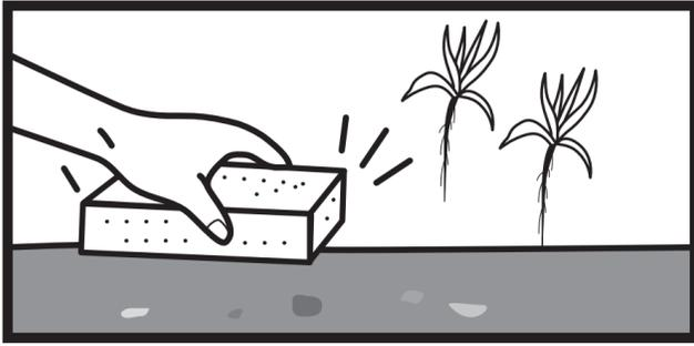
5cmの厚さに本品を敷くので、施工部分をあらかじめ5cm程度掘り下げ、除草・除根し平らにします。(5cm角の角材をあてながら深さを確認してください。)レンガ等を使用し施工部分を叩きながらよく固め、強固にします。
