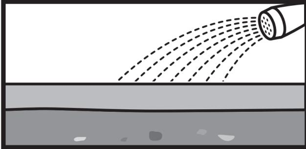
目の細かいジョーロやシャワーガン(ノズル切替できるものはキリまたはシャワー)で2回に分けて均一に丁寧に散水します。1回目は霧状で表面が濡れる程度(色が変わる程度)に散水します。2回目は1時間くらい時間を置いてから、まんべんなく十分に散水します。散水量の目安は、敷いた砂と同量以上です。
