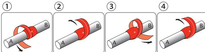
リーク箇所を中心にリーク箇所(中央部)へ戻す。同様に反対のB側へ巻き広げる。再度、リーク箇所(中央部)へ戻す。上重ねて巻き広げる。
