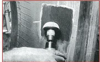
3 TECH低速エア・バッファ (#S-1036) にラバーフック (S-2030) セットし外郭線の内側をバフして下さい。 *作業の際は、必ず目を保護する為にゴーグルをおかけください。バフ後に出たゴミが目を TECH/ハキューム (S-999) で吸い取って下さい。
