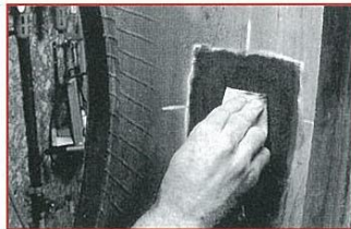
5 バッファ液 (#704) をきれいな布にしみ込ませパフ面をきれいにふき取って下さい。
