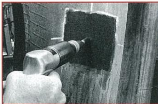
4 TECHエアドリル (S-1035) にカーバイドカッターをセットし、傷の角度に沿って内側から右回転でスチールコードの処理を行って下さい。この作業を最低4回繰り返し、同様に外側からも同じ作業を行って下さい。 *カーバイドカッターは1200回転以下のドリルで使用してください。
