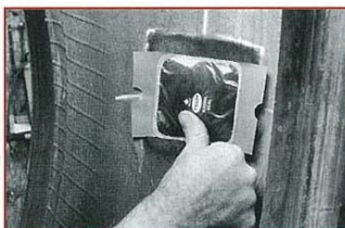
8 指でパッチ中心部分から外側へエアを押し出し保護用ポリビニールを完全に剥しステッチャーローラー (#936) で良く圧着して下さい。
