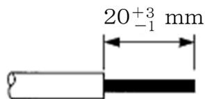
ロ) 電線穴に差し込み、端子ねじを締め付ける。
