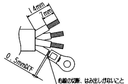
※圧着端子のかしめは  $\left\{ \begin{array}{l} 3.5 \text{ mm}^2 \text{ は } 540 \text{ N} \\ 5.5 \text{ mm}^2 \text{ は } 780 \text{ N} \end{array} \right\}$  1分間の張力に耐えること。
