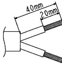
4-3-3 下図の様に結線し、端子ねじを締め付ける。(適正締め付トルク 0.9 N・m~1.2 N・m)
