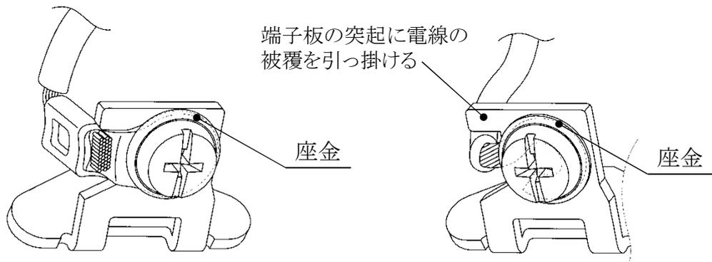
4-3-4 カバー取付用の組立ねじを締め付ける。(適正締め付トルク 0.5 N・m~0.8 N・m)
