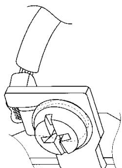
端子板の突起に電線の被覆を引っ掛ける
