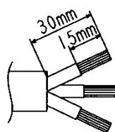
4-3-3 下図の様に結線し、端子ねじを締め付ける。(適正締付トルク 0.6 N·m～0.8 N·m)
