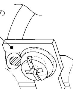
4-3-4 カバー取付用の組立ねじを締め付ける。(適正締付トルク 0.5 N·m～0.8 N·m)
