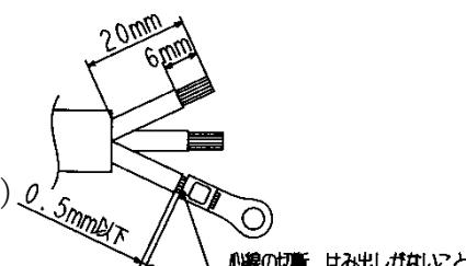
※圧着端子のかしめは  $\begin{cases} 1.25 \text{ mm}^2 \text{ は } 200 \text{ N} \\ 2 \text{ mm}^2 \text{ は } 290 \text{ N} \end{cases}$  1分間の張力に耐えること。
