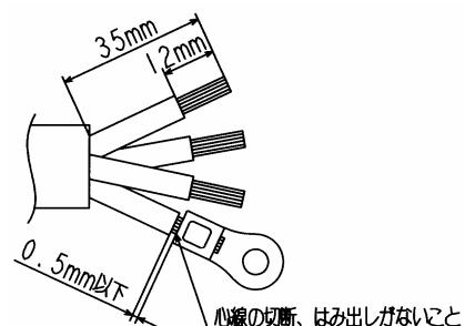
※圧着端子のかしめは  $\left\{ \begin{array}{l} 8 \text{ mm}^2 \text{ は } 980 \text{ N} \\ 14 \text{ mm}^2 \text{ は } 1400 \text{ N} \end{array} \right\}$  1分間の張力に耐えること。
