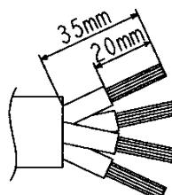
4-3-3 端子ねじを締め付ける。(適正締付トルク 0.9 N·m～1.2 N·m)
