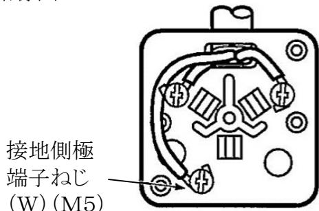
※端子ねじ適正締付けトルク  $1.5 \text{ N}\cdot\text{m} \sim 2 \text{ N}\cdot\text{m}$
