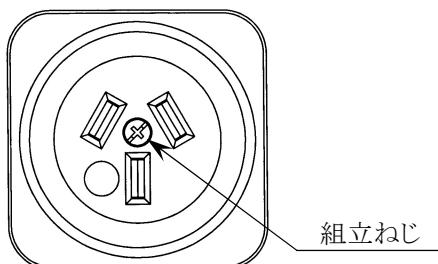
※組立ねじ適正締付けトルク  $0.5 \text{ N}\cdot\text{m} \sim 0.8 \text{ N}\cdot\text{m}$
