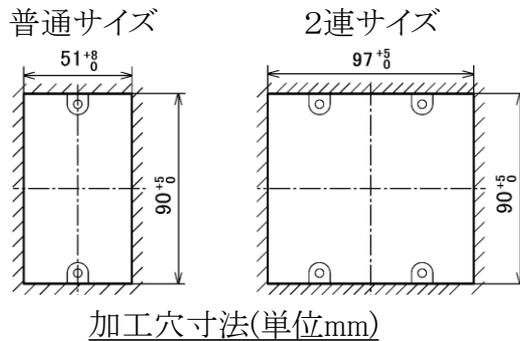
(注1) JIS適合以外のスイッチボックスを用いますと、ボックスカバーの穴の四隅に取付枠の垂下部(下図)が当たり入らない場合があります。
