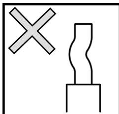
② 器具裏面の電線穴に心線を奥まで1本ずつ確実に差し込んで下さい。
