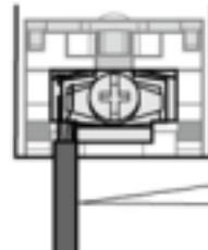
適正締め付けトルク : 0.8 N·m
