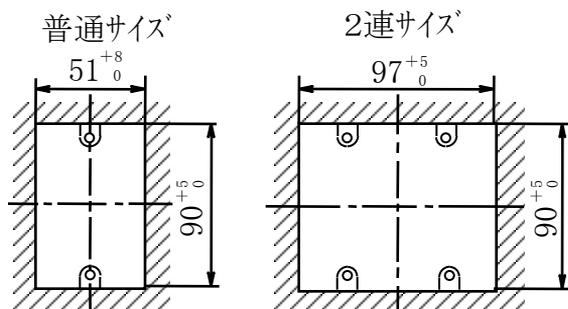
(注1) JIS適合以外のスイッチボックスを用いますと、ボックスカバーの穴の四隅に取付枠の垂下部が当たり入らない場合があります。
