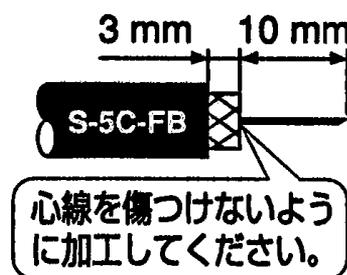
(注意) 心線の先端は斜めにカットしてください。(心線の先端が曲った状態で結線されると、内部のばねが変形し接触不良を起こす恐れがあります。)
