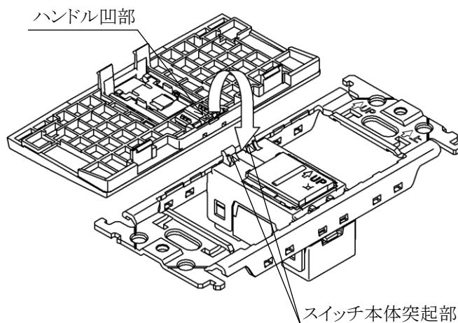
(2) ハンドルの突起部(表面より見て右側)を、スイッチ本体の溝部へ押し込む。
